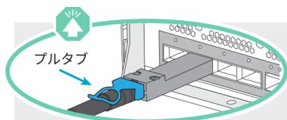
注意：ケーブル コネクタのプルタブの正しい向きを図中の矢印で確認してください。
